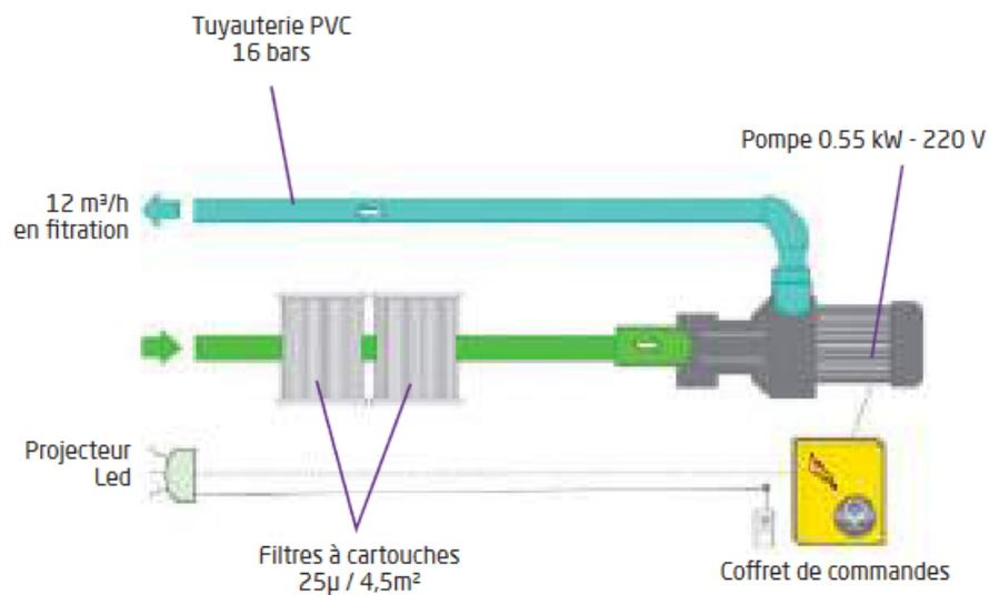
**Bloc Filtrant FB12 avec By-Pass + Projecteur & Coffret électrique :**
