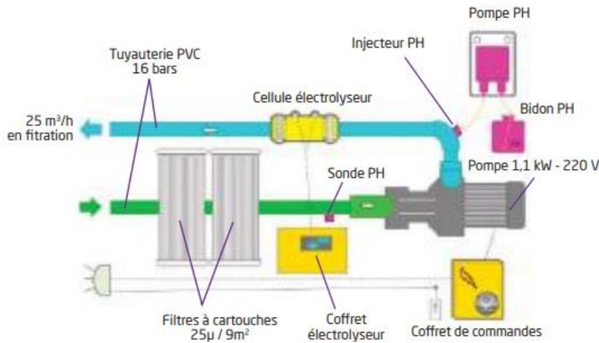
**Bloc Filtrant MX25 LED Blanches ou LED couleurs + télécommande avec Electrolyseur au sel + Régul pH + By-Pass :**
