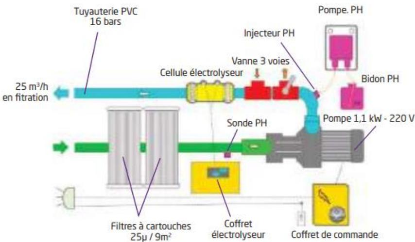
**Bloc Filtrant MX25 LED Blanches ou LED couleurs + télécommande avec Electrolyseur au sel + NCC :**
