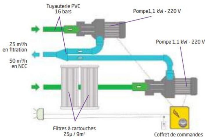
**Bloc Filtrant MX25 LED Blanches ou LED couleurs + télécommande avec Nage à contre-courant (NCC) + By-Pass :**
