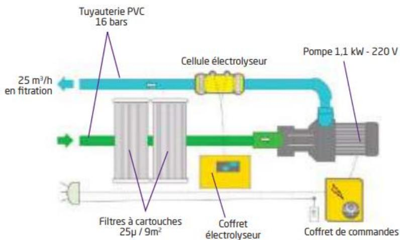
**Bloc Filtrant MX25 LED Blanches ou LED couleurs + télécommande avec Electrolyseur au sel + By-Pass :**
